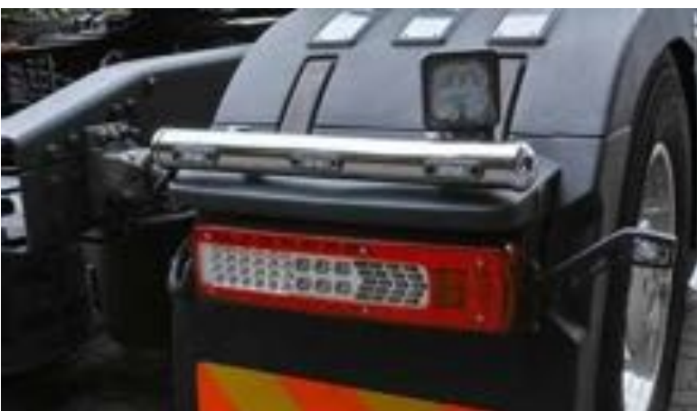
Takavaloputki valmiiksi asennetuilla ja kytketyillä takavaoilla, plug-in
