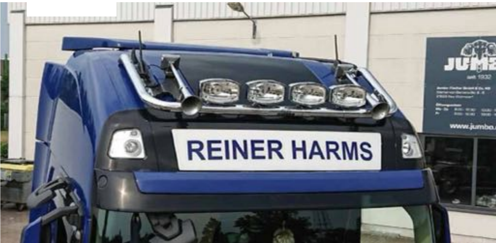
Jumbo Coraline -valot ovat aerodynaamiset ja tuottavat vähän tuuliääniä.
