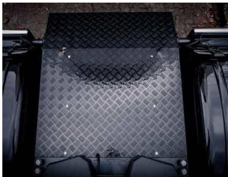
Alumiininen "checker board" -levy (vakiona käsittelemätön alumiinipinta, kuvassa musta pulverimaalaus)
